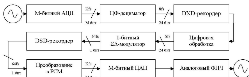
Рис. 2. Реальная схема записи и воспроизведения в формате DSD
